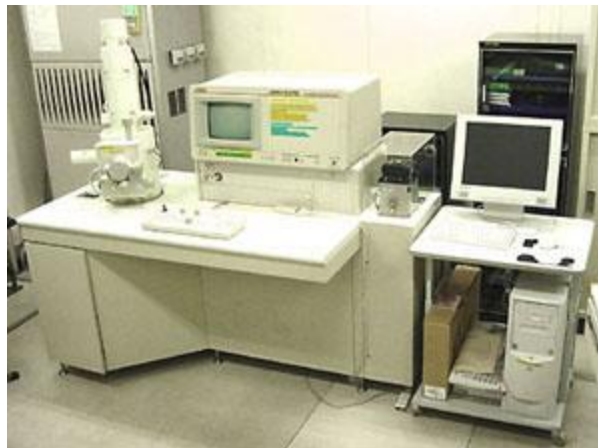
Figura 6: Equipamento utilizado para a Microscopia- Jeol JSM-5310 [12]
