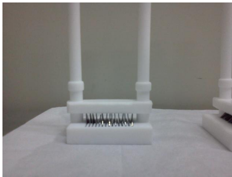
Figura 2: Suporte de Teflon utilizado para fixação das amostras
