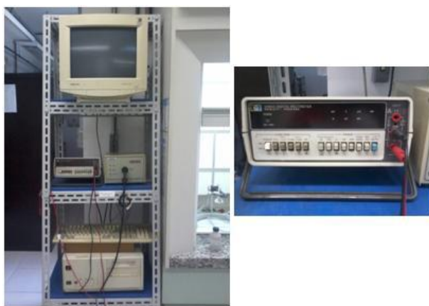
FIGURA 5: Potenciostato e multímetro utilizados durante os experimentos
